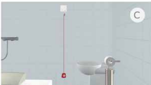
Zugtaster als Rufeinheit zur sicheren Auslösung im Bereich von Nasszellen. Die spritzwassergeschützte Einbaueinheit wird oberhalb des Wasseraustritts / Brausekopfes montiert und kann durch optionalen Dichtsatz zusätzlich Spritzwasser (IP67) geschützt montiert werden. Die rote 2 m lange PVC-Zugschnur mit Knauf und Rufsymbol ermöglicht eine sichere Rufauslösung, auch von am Boden liegenden Personen.
